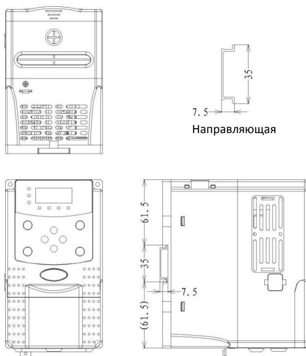
Рисунок 2-5. Габариты преобразователя и размеры монтажных отверстий
